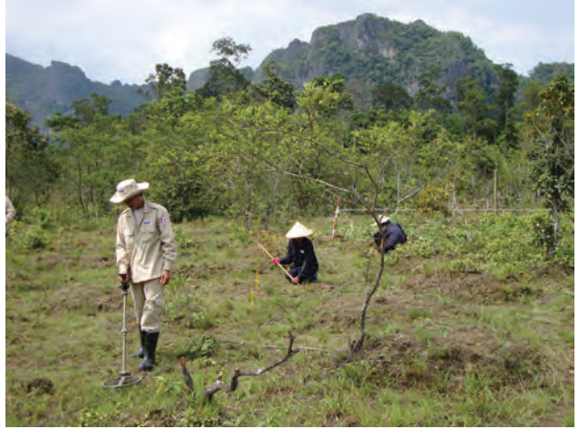
ໜ່ວຍງານກວດກູ້ ກຳລັງໃຊ້ເຄື່ອງກວດ ເພື່ອຄົ້ນຫາລະເບີດລູກຫວ່ານ ແລະ ລບຕ ຊະນິດອື່ນໆ ຢູ່ສະໜາມກວດກູ້
